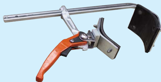
Morsa manuale da banco per estintori polvere-schiuma (diametro 80-190 mm) Bench manual vice
